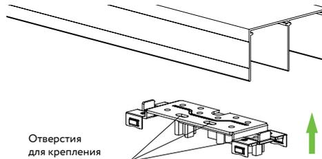
4 Устраните зазор между верхним роликом доводчика и ответной планкой. Для этого опустите ответную планку, вращая регулировочный винт по часовой стрелке.
