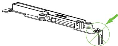
Перед началом монтажа на NOVA, отсоедините от доводчиков монтажные вилки
