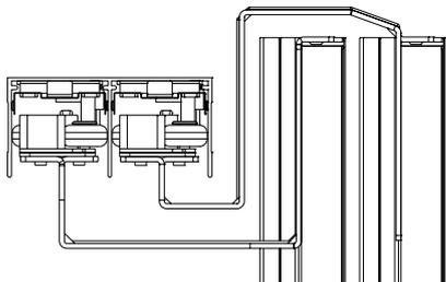
1 Установите дополнительный кронштейн на дверь, как показано на рисунке. При установке край доводчика должен совпадать с краем кронштейна.
